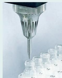
L'esclusivo separatore LotusStream® consente il frazionamento di piccoli volumi senza dispersione del solvente.
