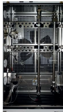
Il forno in grado di accogliere fino a 6 colonne da 30 cm in serie e la termostatazione mediante circolazione forzata d'aria rappresentano un plus per le analisi in GPC
