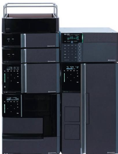
Combinando un eccellente sistema di pompaggio, un autocampionatore dalle performance elevate, un capiente forno colonna e detector termostatati, questo sistema **garantisce un'eccezionale riproducibilità dei risultati analitici e una rapida stabilizzazione della linea di base.**
